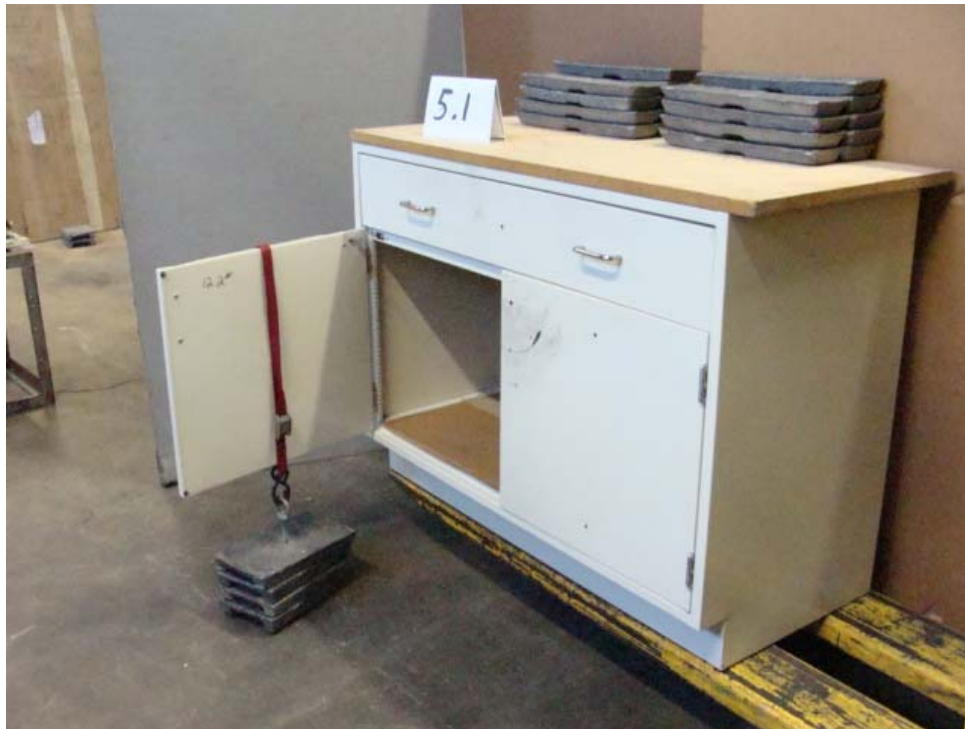
Photo 4: 5.1 Door Hinge Test
